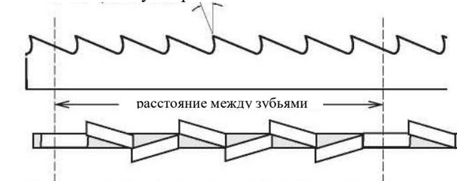
Этот тип ленточного полотна является наиболее подходящим для резки сортового профиля, толстостенных труб большого диаметра, а также для резки цельных прутков при максимальной производительности станка. Доступные шаги: 3–4/4–6.
