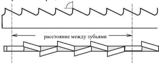
Другое преимущество, предлагаемое при использовании этого типа лезвия, состоит в том, что с помощью только одного такого лезвия можно выполнять резку широкого спектра различных по размеру и типу материалов.
